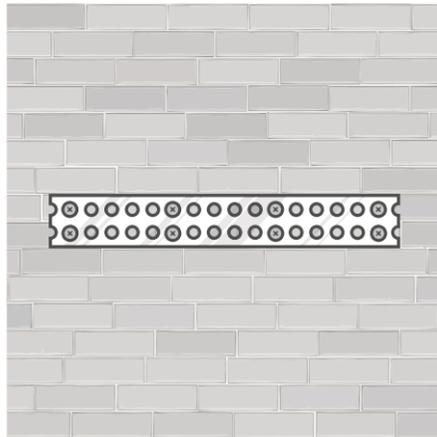
Fissare il profilo di partenza al supporto murario in maniera perfettamente planare tramite appositi tasselli a espansione a testa piatta. Si consiglia di tenere una distanza di circa 5 cm da terra.
